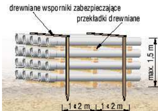
Rys. Składowanie rur na placu budowy
